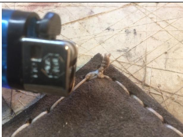
Da ich als Faden einen gewachsten Nylonfaden verwende, knote ich die Enden dann mehrfach zusammen und verschmelze mit Hilfe eines Feuerzeugs den Knoten. Somit kann sich dieser dann nicht mehr öffnen.
